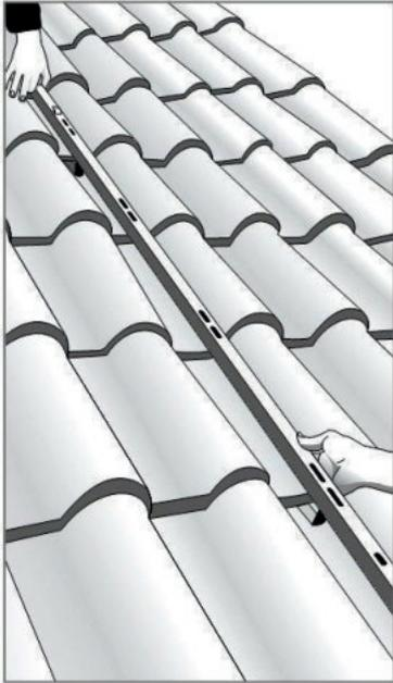
2) Kollektorrahmen mit Schrauben befestigen.
